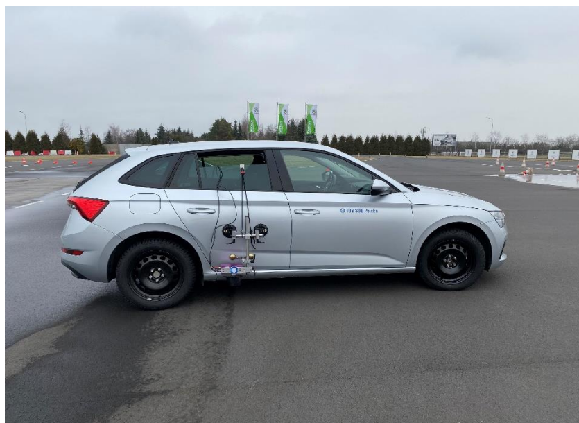
Fot. 4. Pojazd badawczy z oprzyrządowaniem pomiarowym DATRON
