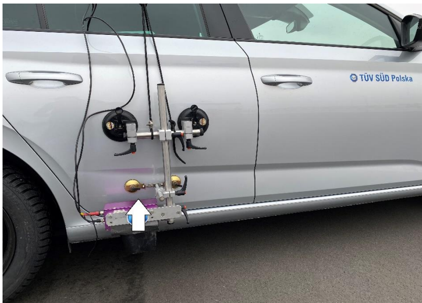
Fot. 5. Fotodiody oprzyrządowania pomiarowego DATRON.
