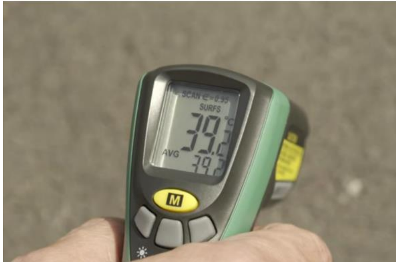
Fot. 1 Pomiar temperatury toru.
