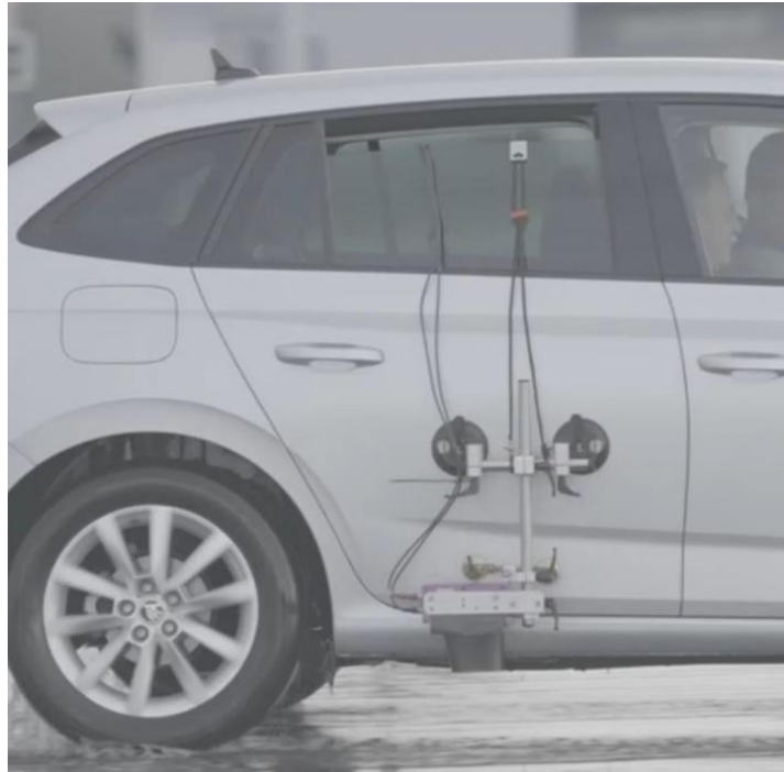
Fot. 3 Fotodiody oprzyrządowania pomiarowego DATRON.
